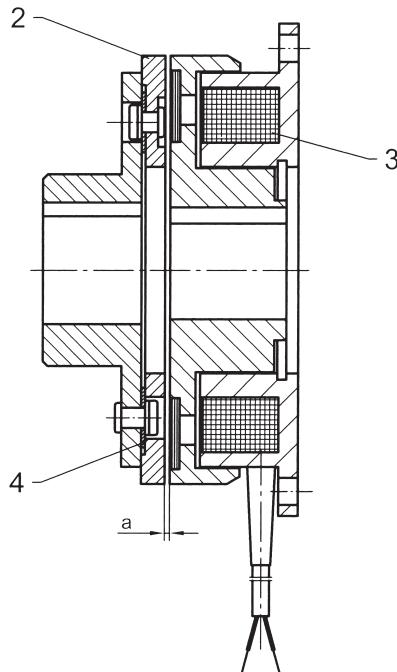
Elektromagnet-Bremse OLB (Anker F1)
