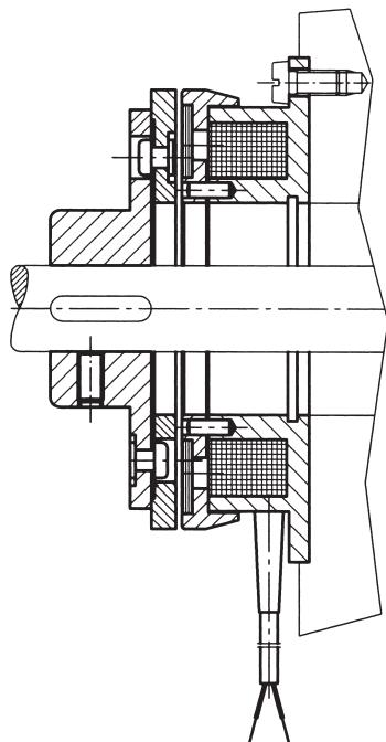
Flanschmontierte Bremse OMB
