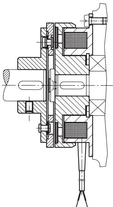
Wellenmontierte Kupplung OLG
