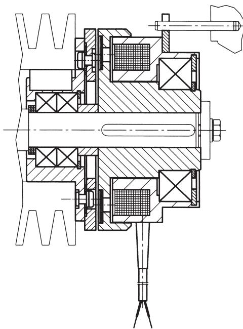
Flanschmontierte Bremse OLB
